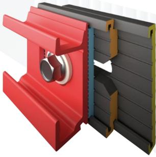
Os calços estão disponíveis em diversas espessuras, variando alguns milímetros entre eles, o que permite ajustes na planimetria de até 2 centímetros. Esses calços são simples de usar e destinam-se a corrigir pequenos desníveis e inclinações na planimetria.
